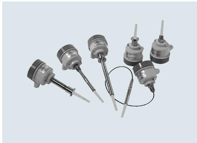
Pointek CLS200（标准型）是一个反相频移点式电容物位计，它可选杆式 / 缆式和可选配置输出。它适用于检测液体，固体，浆料，泡沫和界面。
