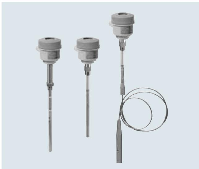
Pointek CLS300（标准型）是一个反相频移电容点式物位计，它带有可选杆/缆式和可配置输出。它适用于在高温和高压的苛刻的环境中，探测液体，固体，浆料，泡沫和界面。
